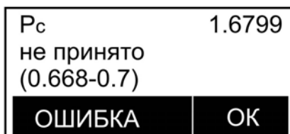
Рис. 7 – Экран ЖКИ в режиме «Ошибка»
