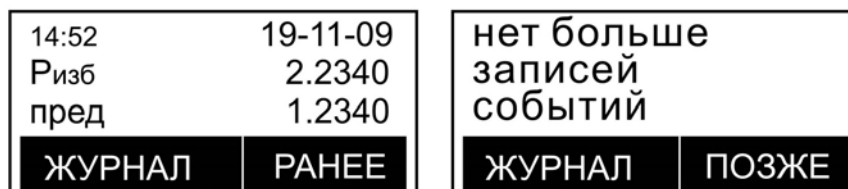
Рис. 11 – Экран ЖКИ в режиме «Журнал»
