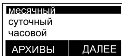
Рис. 8 – Экран ЖКИ в режиме «Архивы»
