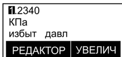
Рис. 6 – Экран ЖКИ в режиме «Редактирование»
