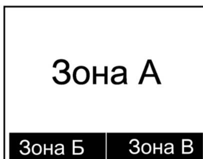
Рис. 3 – Зоны экрана ЖКИ
