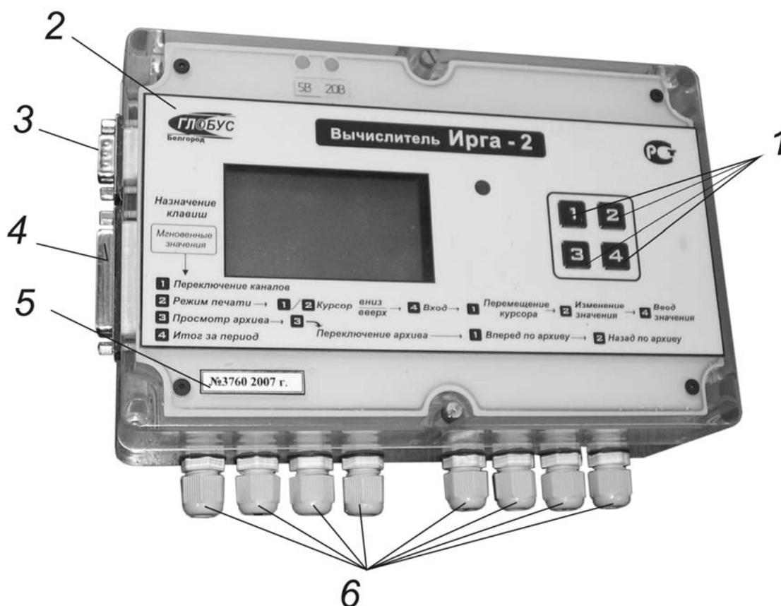
1 – клавиатура; 2 – товарный знак; 3 – разъем RS-232 для подключения к внешним устройствам; 4 – разъем для подключения принтера; 5 – надпись с заводским номером вычислителя и годом изготовления; 6 – кабельные входы для подключения ПП и питания.
