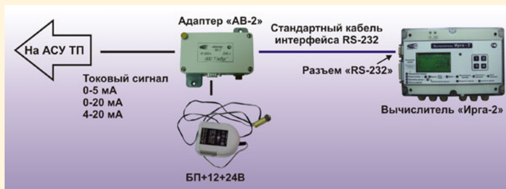
Рис. 1. Схема с использованием унифицированного токового сигнала. В схеме используется адаптер «АВ-2», подключаемый к вычислителю стандартным кабелем интерфейса RS-232. Диапазон выходного токового сигнала адаптера «АВ-2» может быть 0-5 мА, 0-20 мА или 4-20 мА (определяется при заказе адаптера «АВ-2»). Величина сигнала пропорциональна мгновенному расходу измеряемой среды. Сигнал адаптера активный, т.е. не может использоваться в двухпроводной схеме включения.
