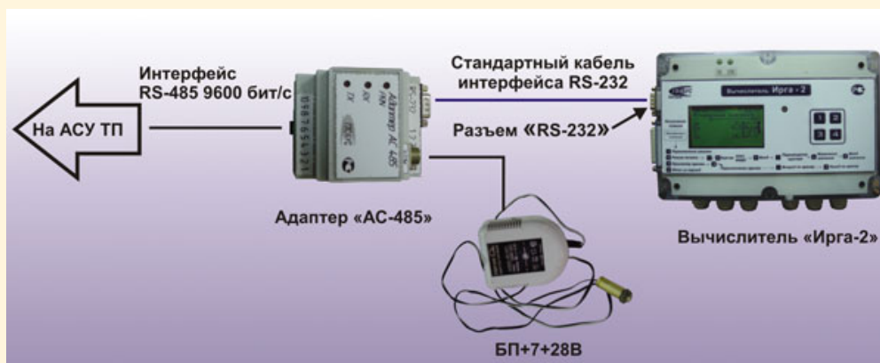
Рис. 4. Схема с интерфейсом RS-485 (соединение типа точка – точка). В схеме используется адаптер «АС-485», подключаемый к вычислителю стандартным кабелем интерфейса RS-232. Со стороны АСУ ТП может использоваться цифровой контроллер (или компьютер) с интерфейсом RS-485, или с интерфейсом RS-232 и вторым адаптером «АС-485». Длина линии связи RS-485 – до 1 км, линия гальванически изолирована в адаптере «АС-485» и имеет единую цепь питания (т.е. адаптеры «АС-485» могут работать от одного блока питания). Протоколы обмена и программное обеспечение соответствуют рис. 3.
