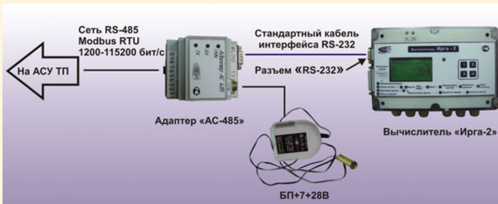
Рис. 5. Схема с интерфейсом RS-485 (сетевое соединение). В схеме используется адаптер «АС-485», подключаемый к вычислителю стандартным кабелем интерфейса RS-232, сетевой протокол – Modbus RTU, обеспечивается адаптером «АС-485». Со стороны АСУ ТП может использоваться цифровой контроллер (или компьютер) с интерфейсом RS-485 или с интерфейсом RS-232 и дополнительным адаптером «АС-485». Длина линии связи RS-485 зависит от скорости передачи (1200-115200 б/с), может быть более 1 км, линия гальванически изолирована в адаптере «АС-485» и имеет единую цепь питания (т.е. все адаптеры «АС-485» могут работать от одного блока питания). В сеть могут объединяться до 32 вычислителей (с адаптерами «АС-485») и любых других устройств, поддерживающих Modbus RTU.
