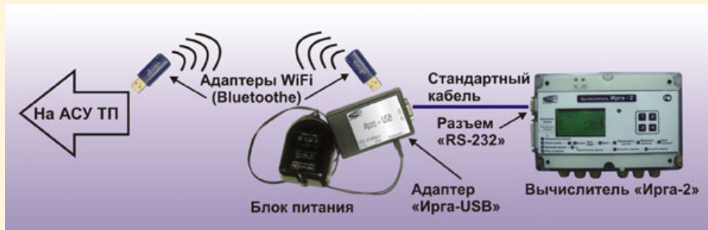
Рис.7. Схема с интерфейсом USB. В схеме используется адаптер «USB», подключаемый к вычислителю стандартным кабелем интерфейса RS-232. К разъему «USB» адаптера «USB» подключается адаптер WiFi (реже адаптер Bluetooth в силу небольшого радиуса действия). Со стороны АСУ ТП может использоваться цифровой контроллер (или компьютер) с интерфейсом USB и адаптером WiFi (Bluetooth). Использование адаптера WiFi позволяет объединить вычислители в сеть на основе стандартов беспроводных сетей wi-fi. Адаптер WiFi работает на скоростях 1, 2, 5,5 и 11 Мбит/с, используя автоматическую подстройку скорости для обеспечения оптимальной скорости и надежности подключения. Эти адаптеры обеспечивают связь в радиусе от 100 м до нескольких километров (при использовании наружной антенны).
